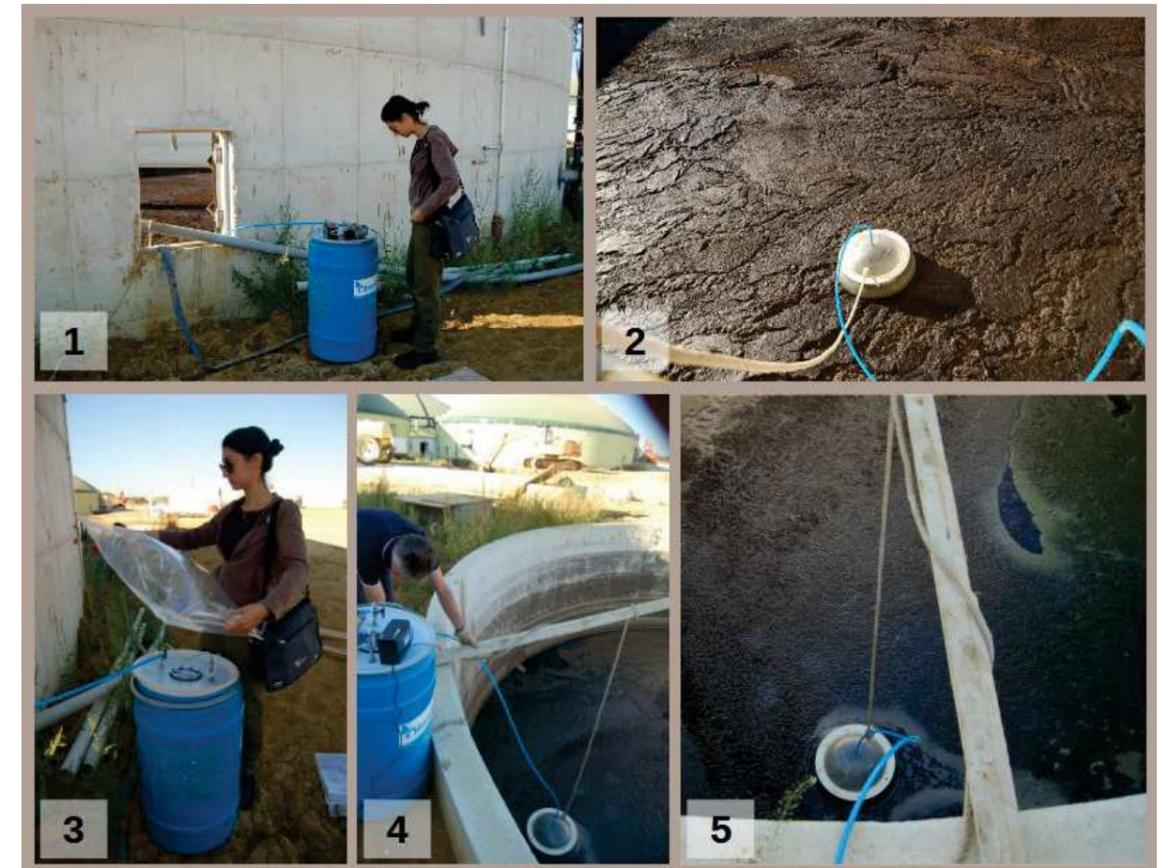
Illustration 2: Clichés 1, 2 et 3, prélèvement sur le digestat dans le silo ; Clichés 4 et 5, prélèvement sur le bassin tampon.
